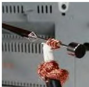
ロッドアンテナに芯線だけを巻きつけます。
