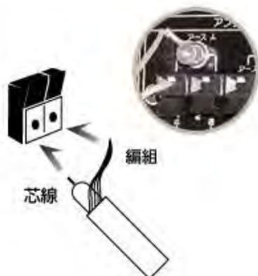
2個のアンテナ端子のうち、アース側端子に同軸ケーブルの網線を接続、もう一方の端子に芯線を接続します。
